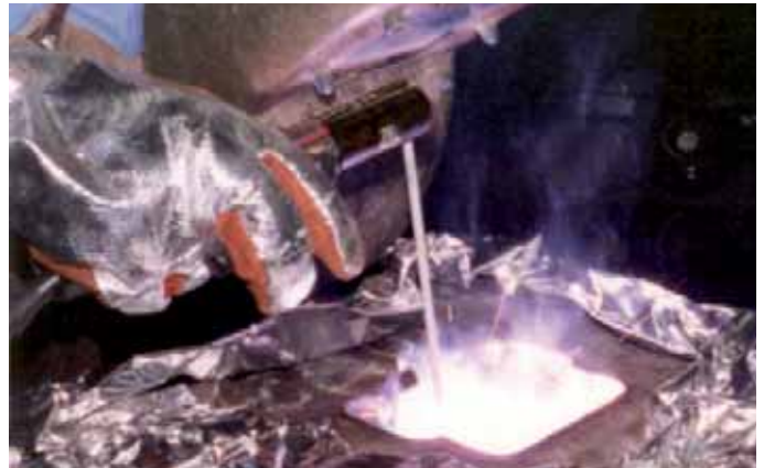
Lichtbogenhandschweißen mit dem Abdecken der Bauteile
