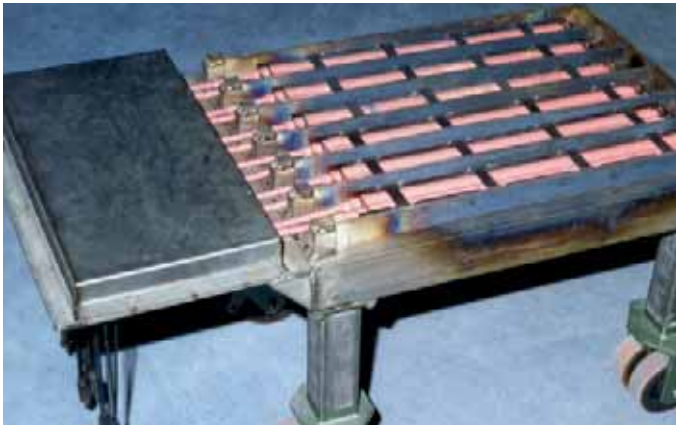
Vorwärm- und Warmhaltetisch für das Schweißen von Werkzeugen
