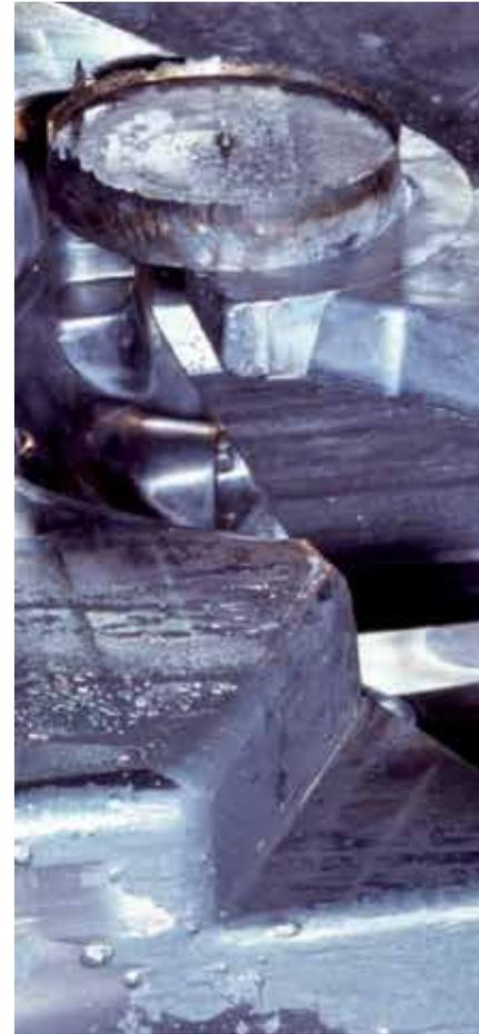
**Als Grundregel gilt:** Zur Vermeidung von Grobbrüchen und zur Verminderung von Temperaturwechsellrissen und Spannungsrissen sollten immer maximale Zähigkeit und Duktilität angestrebt werden. Die Härte bzw. Festigkeit sollte derart gewählt werden, dass plastische Verformung durch die äußere Belastung und Erosionsschädigung weitgehend vermieden werden, dabei aber maximale Zähigkeit im Vordergrund steht.
