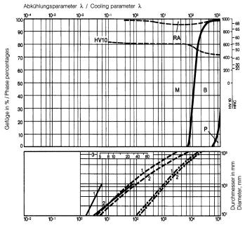
Kühlzeit von 800°C auf 500°C in Sek. / Time of cooling from 800°C to 500°C in seconds
