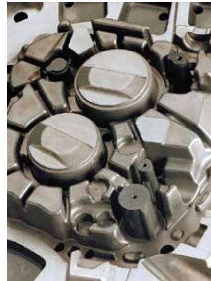
Bauteil hergestellt aus BÖHLER W400 VMR
