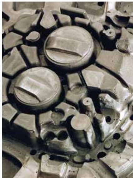
Bauteil hergestellt aus 1.2343 ESU
