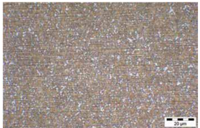
Primäre Karbide (weiß) eingebettet in eine vergütete Schnellarbeitsstahlmatrix.
