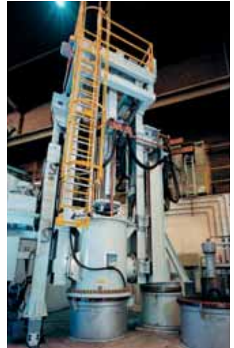
VLBO – Vakuum-Umschmelz-Lichtbogenofen VAR – Vacuum Arc Remelting Furnace
