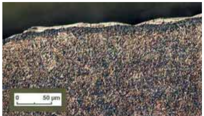
Oberflächenaussehen nach Senkerodieren mit Kupfer-Elektrode Surface finish following spark eroding with a copper electrode
